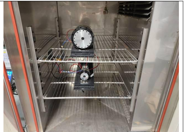
序号 4-2 高温工作试验样品放置
